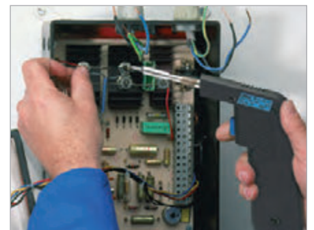
Anwendung Lötspitze Ersa Multi-Sprint
