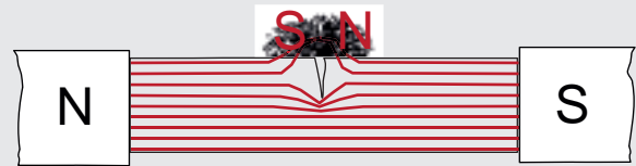
GESTÖRTER VERLAUF DER MAGNETISCHEN FELDLINIEN DURCH EINEN RISS IM WERKSTOFF
