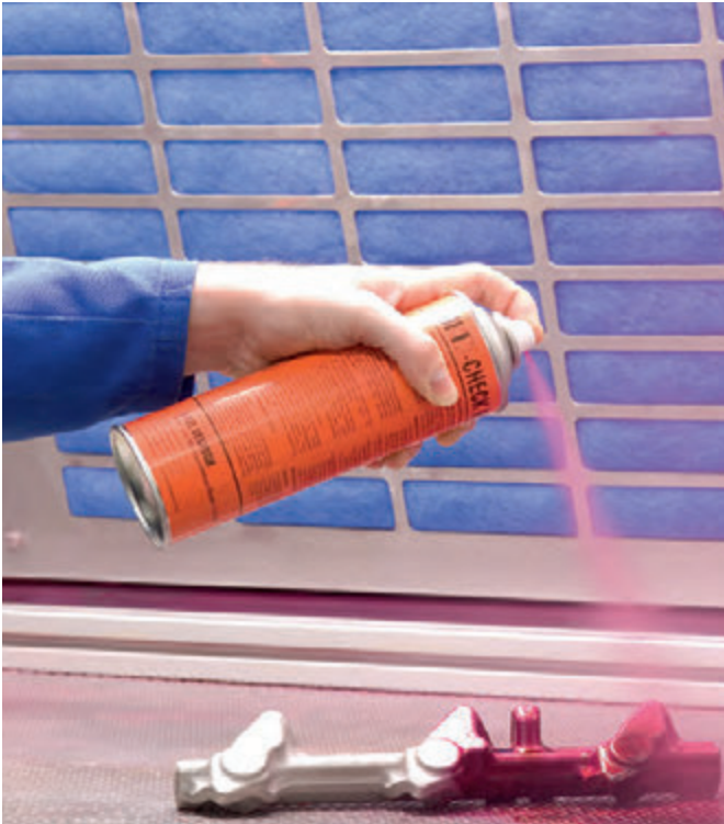
Die Untersuchung wird aus Umweltschutz- und Arbeitsschutzgründen möglichst in einer kombinierten Sprüh- und Waschkabine mit Absaugung durchgeführt
