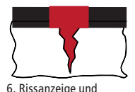
6. Rissanzeige und Endreinigung
