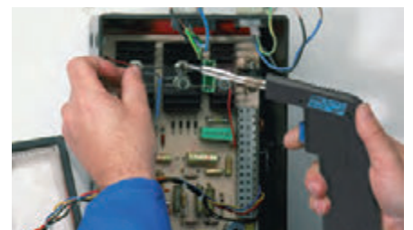
Anwendung Lötspistole ERSA Multi-Sprint
